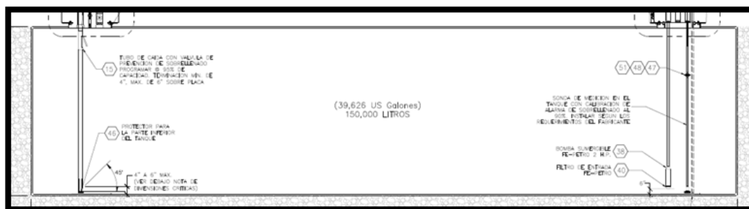
Figura 6. Tanques subterráneos de doble pared de acero al carbón y revestidos con fibra de vidrio. FUENTE: COSTCO. COSTCO MEXICO-UPDATED MASTER PLANS 3x4 -MECHANICAL-05.30.18 (2)
