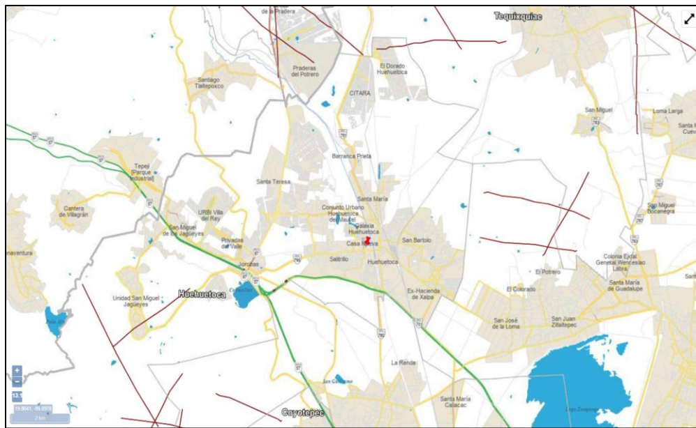
FIGURA 18. FALLAS GEOLÓGICAS A LOS ALREDEDORES DE LA CIUDAD DE HUEHUETOCA (LÍNEAS ROJAS). PIN ROJO INDICA LA UBICACIÓN DEL PROYECTO. FUENTE (INEGI, 2022D)
