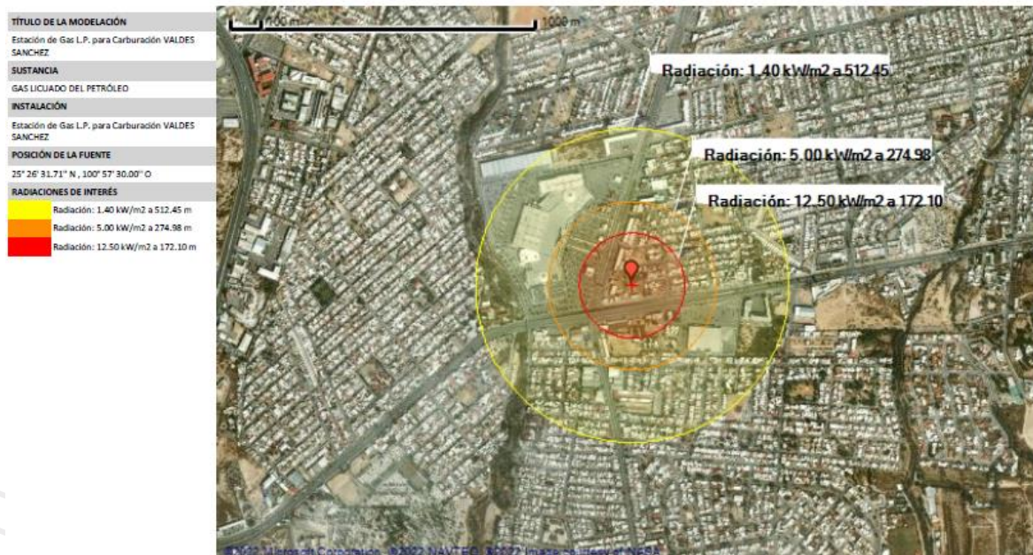
Ilustración 22. Radios de afectación en caso de una BLEVE en la Estación
