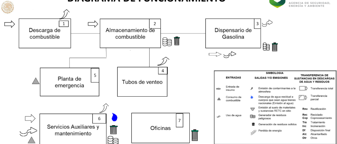
Figura 13. Diagrama de funcionamiento de la Estación de Servicio
