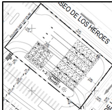
Figura 4. Islas con dispensarios dobles.
