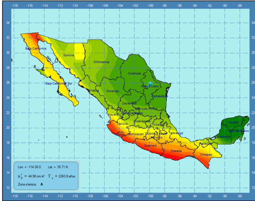
Figura 27. Regionalización sísmica para el (AI) y (AP), del Programa de Diseño Sísmico (PRODISIS) versión 4.1
