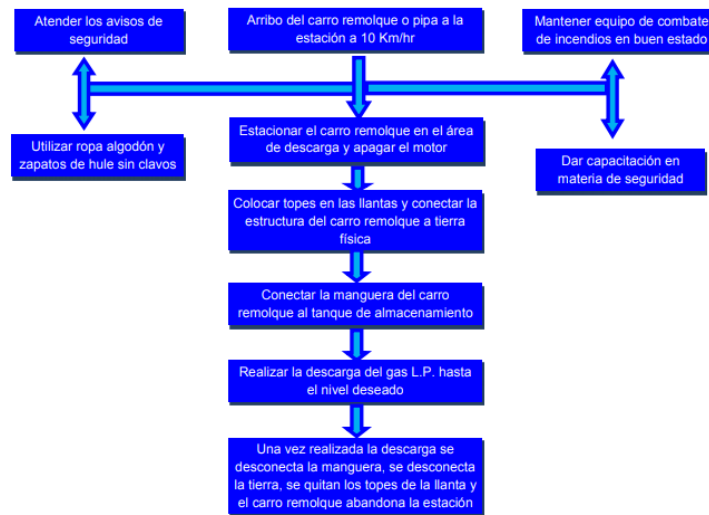
Diagrama de flujo de descarga de Gas L.P. de carro remolque a tanques de almacenamiento
