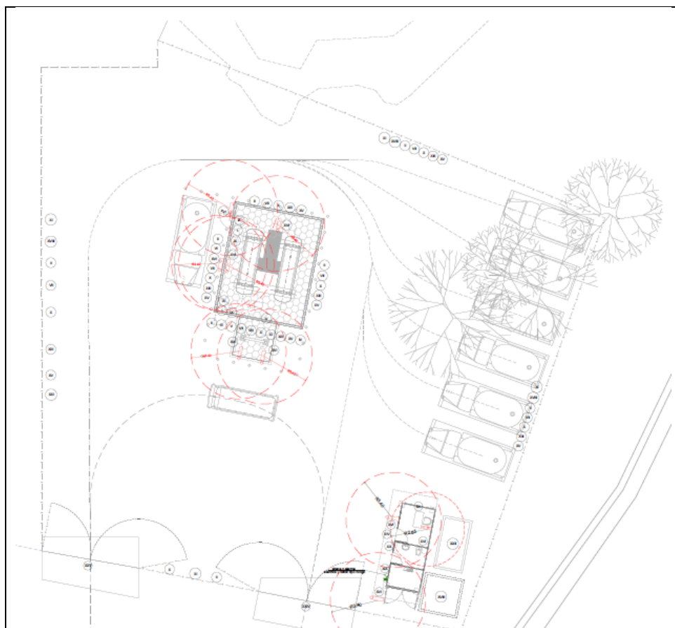
FIGURA III.1.3.8. DISTRIBUCIÓN DE EXTINTORES EN LA ESTACIÓN | FUENTE: PLANO DEL PROYECTO CONTRA INCENDIO ANEXO 3 EXPEDIENTE TÉCNICO DEL PROYECTO
