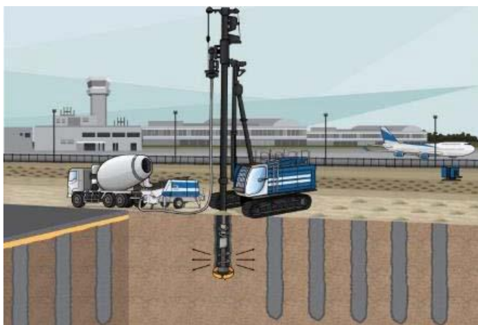
Figura 3.3 Perforación y colado de inclusiones
