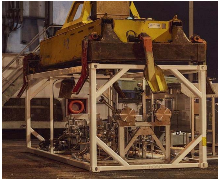
Figura 20.- Patín de bombas de descarga.
