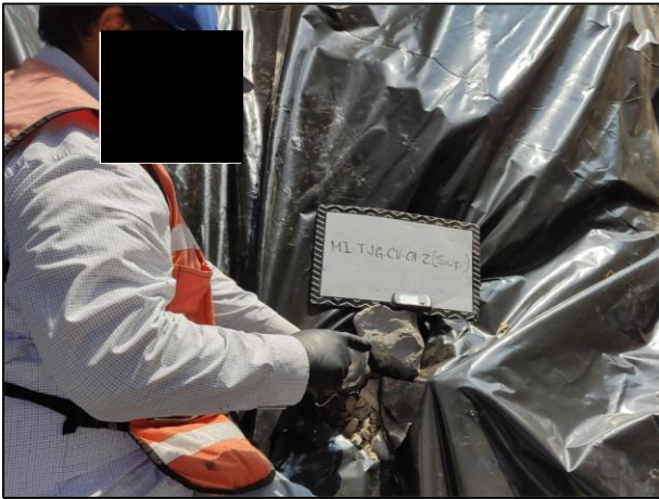
3. Con apoyo del cucharón de acero inoxidable se tomaron las muestras superficiales dentro del Área Afectada.
