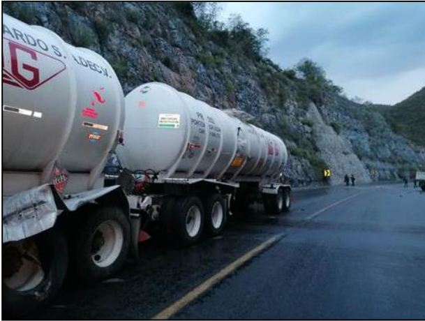
1. Unidad de transporte accidentada, donde el segundo tanque se vio afectado al sufrir una fisura, provocando el derrame de la Gasolina transportada.
