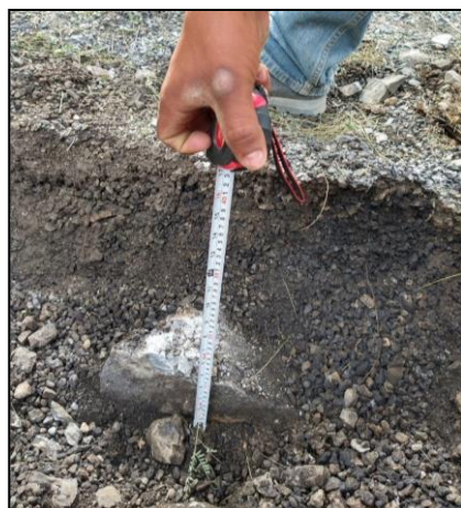
11. Se tomó la profundidad de infiltración de la Gasolina derramada, con apoyo de una cinta métrica.
