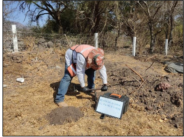
08. Se realizó la toma de muestra a diferentes profundidades en la Periferia del Área Afectada.
