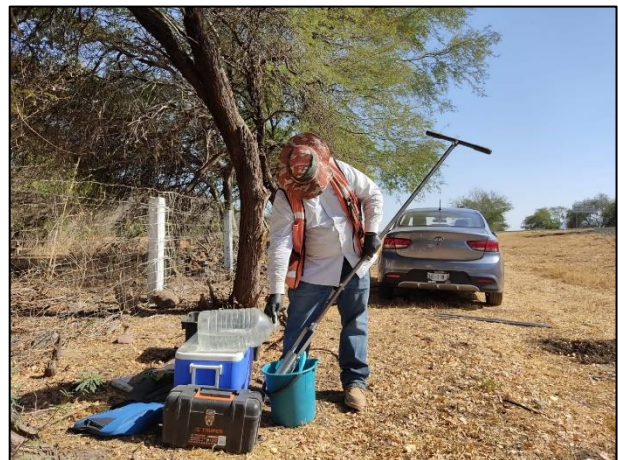
12. El personal encargado de la toma de muestras lavó el equipo utilizado con jabón libre de fosfatos.
