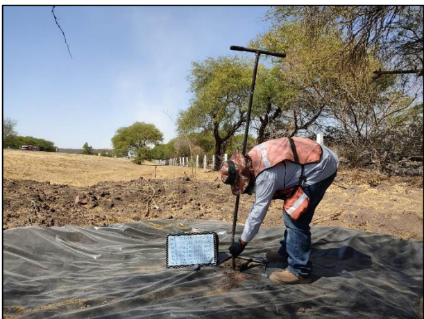
05. Se utilizó Hand Auger para la toma de muestras a diferentes profundidades.
