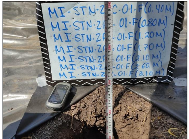
04. Las profundidades de los puntos de muestreo fueron verificadas con apoyo de un flexómetro.
