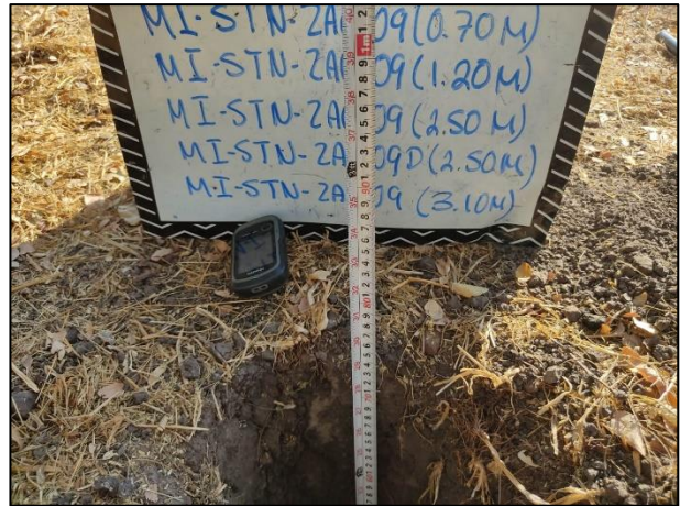
10. Se realizó la medición de las profundidades en los puntos de muestreo de acuerdo con el plan de muestreo inicial.
