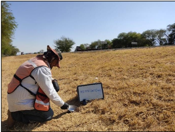
13. Se realizó la toma de muestra testigo fuera del Área Afectada con apoyo del cucharón del acero inoxidable.
