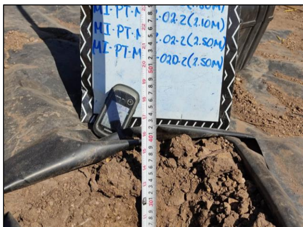
5 - Las profundidades de los puntos de muestreo fueron verificadas con apoyo de flexómetro.
