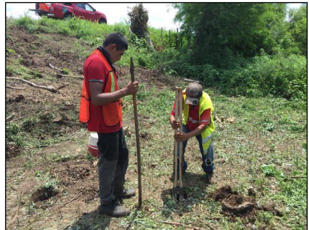
6 - Con apoyo de recurso humano y de una pocera, se realizaron sondeos en el sitio para conocer la infiltración de la Gasolina derramada en suelo natural.
