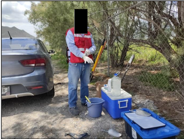
01 - Para la toma de muestras se utilizaron guantes al inicio y entre cada toma, para evitar la contaminación cruzada de las mismas.
