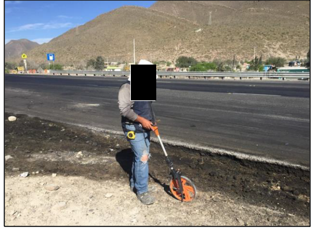
02 - Con apoyo de odómetro se tomaron las medidas de la Zona afectada por el derrame de Diésel automotriz.
