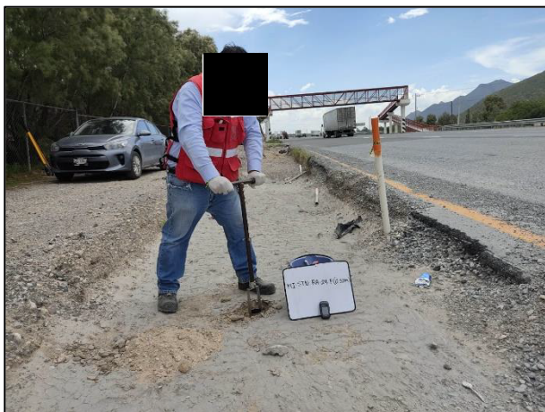
05 - Se realizó la toma de muestras de acuerdo con el Plan de Muestreo. Toma de muestra en el fondo de la Zona de Extracción B.
