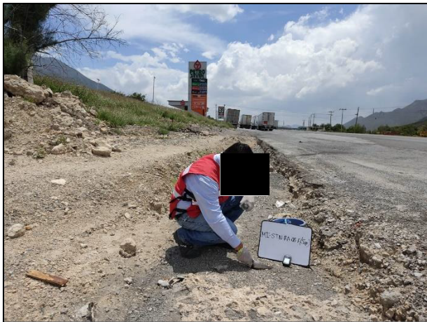
09 - Con apoyo del cucharón de acero inoxidable se realizó la toma de muestras superficiales en fondo de las Zonas de Extracción.
