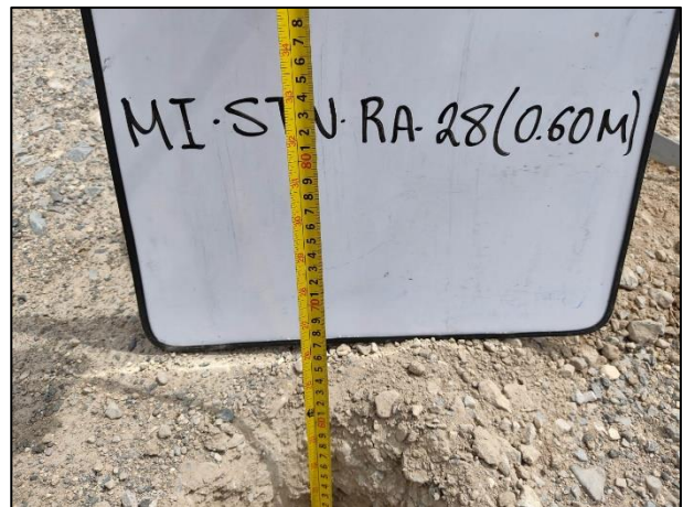
04 - Las profundidades de los puntos de muestreo fueron verificadas con apoyo de flexómetro.
