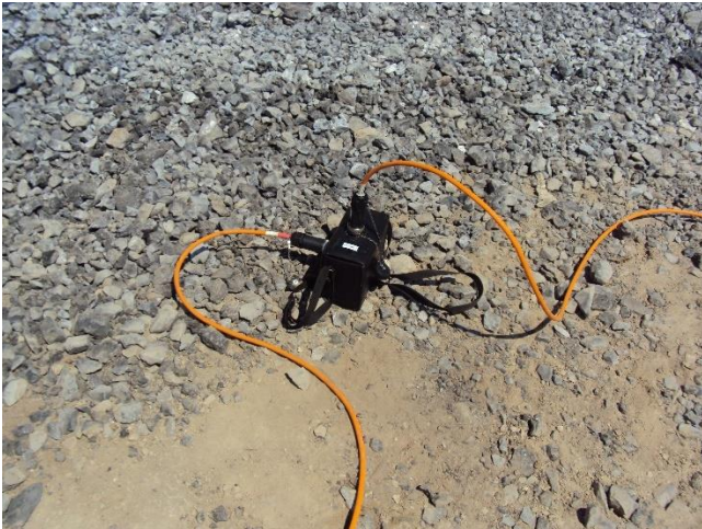
Figura 28. Conexión de cables para inyección de corriente y lectura
