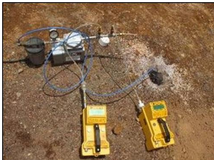
Figura 7-27. Equipos de monitoreo para medición de COVs (fotoionizadores)
