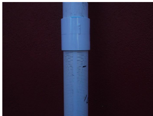
Figura 7-10. Enroscado de tubería ranurada y tubería lisa
