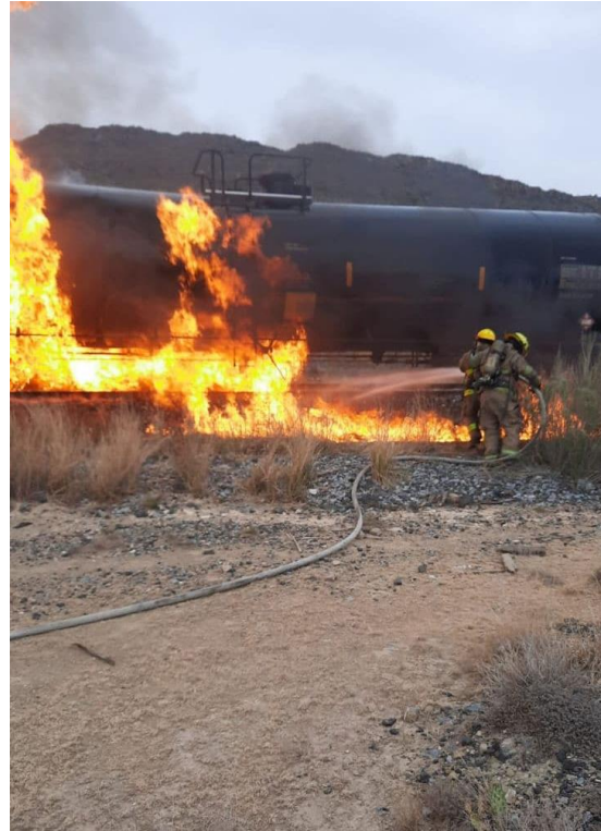
Figura 2.4. Control del fuego por combustión de combustible mediante la aspersión de agua
