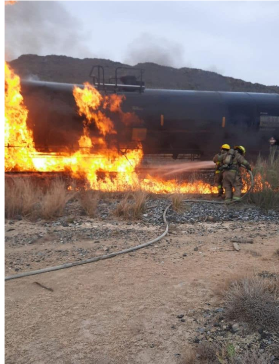
Figura 2-4. Control del fuego por combustión de combustible mediante la aspersión de agua
