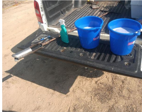
Figura 5.4. Lavado de equipo Hand Auger
