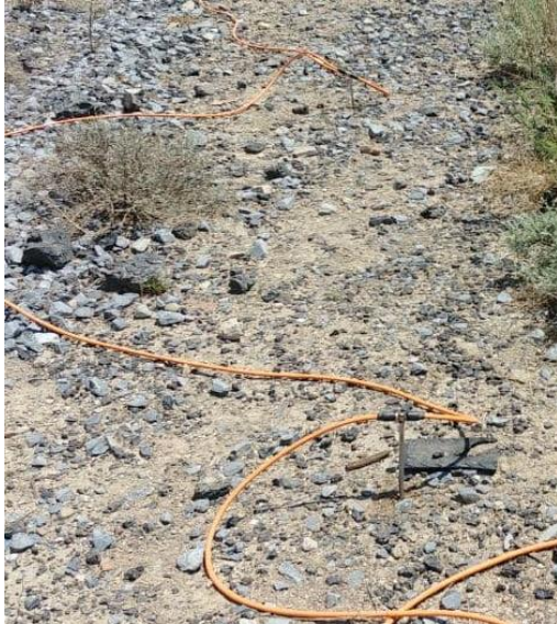
Figura 5.37. Conexión de electrodo con el cable de inyección de corriente y lectura
