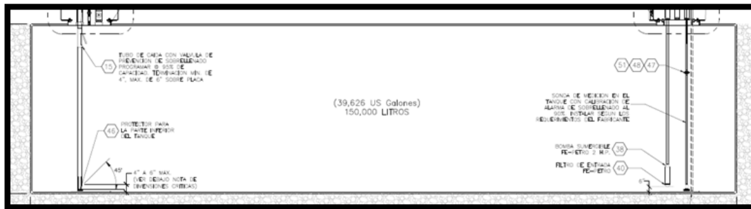
Figura 6. Tanques subterráneos de doble pared de acero al carbón y revestidos con fibra de vidrio. FUENTE: COSTCO. COSTCO MEXICO-UPDATED MASTER PLANS 3x4 -MECHANICAL-05.30.18 (2)
