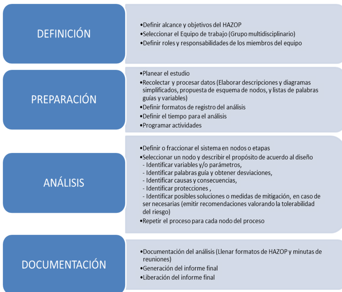
Diagrama IX.1. Procedimiento para realizar la metodología HAZOP.
