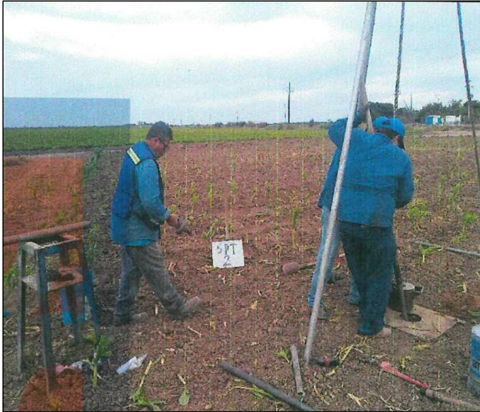
Fotografía 11. Vista de la realización del SPT #2.
