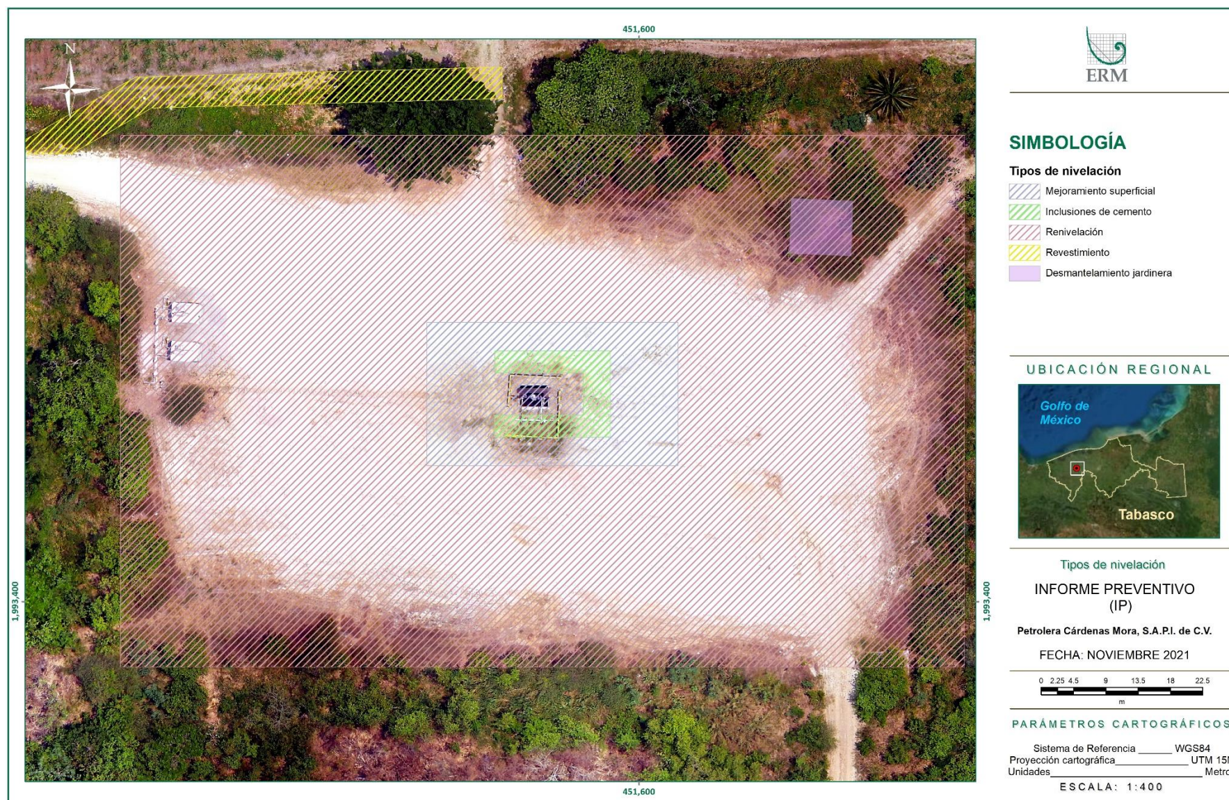
Figura 3.4 Tipos de trabajo de nivelación, mejoramiento, reforzamiento y revestimiento en distintas zonas de la plataforma
