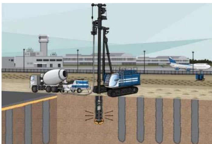
Figura 3.3 Perforación y colado de inclusiones
