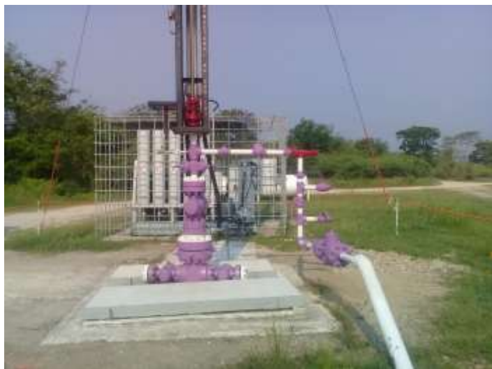
Figura 26. Vista típica de un bombeo mecánico accionado hidráulicamente
