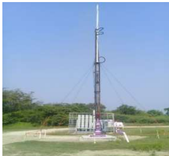
Figura 26. Vista típica de un bombeo mecánico accionado hidráulicamente
