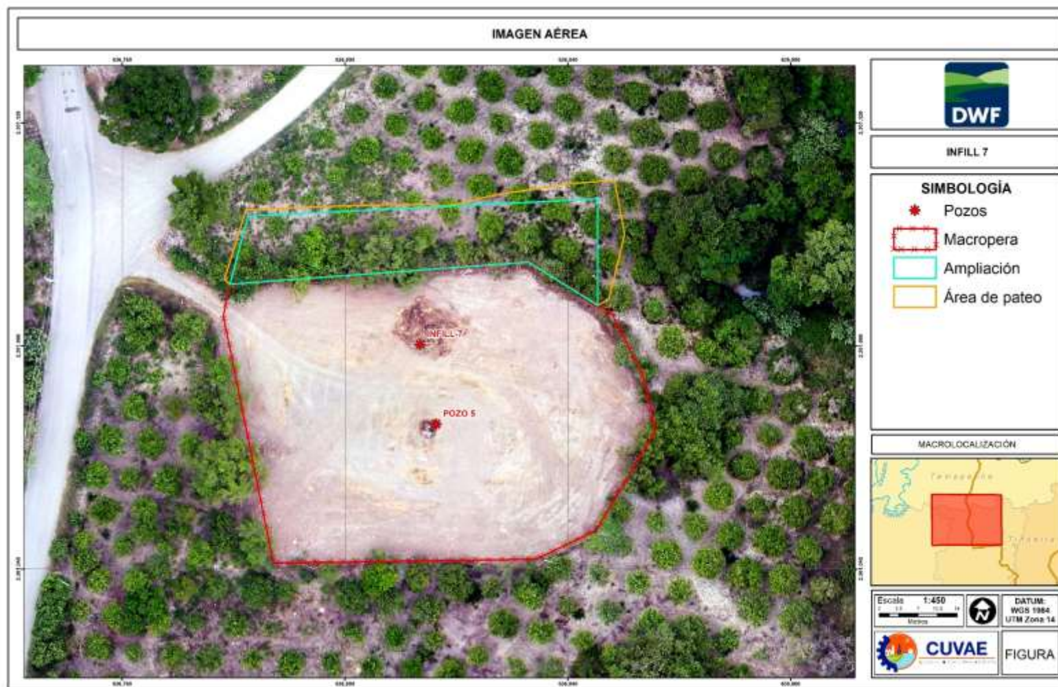
Figura III.1-3.- El proyecto contempla la ampliación de la plataforma del pozo MIQUETLA- 5 para la perforación del pozo INFILL- 7.
