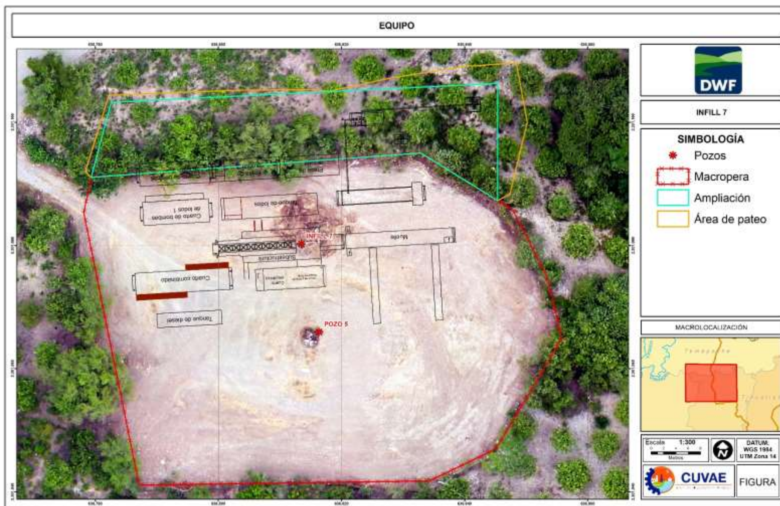
Figura III.1.2.5-2.- Distribución del equipo de perforación.
