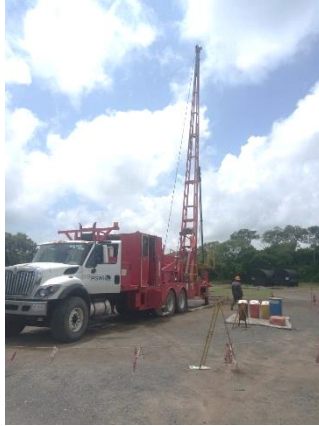
Registro Fotográfico No 4. Actividad operativa de inducción mecánica con unidad de suabeo en pozo Laja 11DEL.
