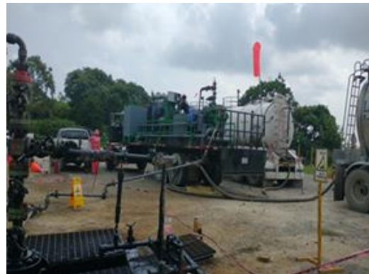
Registro Fotográfico No 12. Actividad de bombeo de sistema orgánico para circulación del pozo la Laja 11DEL.
