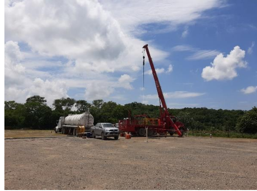
Registro Fotográfico No 1. Actividad operativa de recuperación de sarta de velocidad (50 mts) en el Pozo La Laja 11DEL.
