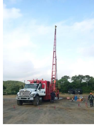
Registro Fotográfico No 4. Actividad operativa de inducción mecánica con unidad de suabeo en pozo Laja 11DEL.
