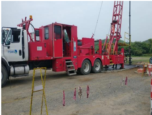
Registro Fotográfico No 6. Actividad operativa con unidad de suabeo para calibración de pozo con cortador de parafina en pozo Laja 11DEL.
