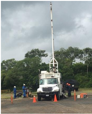
Registro Fotográfico No 5. Actividad operativa con unidad línea de acero para realizar calibración de tubería y colocación de tapón PX en pozo Laja 11DEL.
