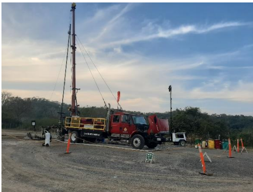
Registro Fotográfico No 18. Actividad de suabeo, mediante calibración de pozo e inducción mecánica y recuperación de fluido de trabajo en pozo Laja 11DEL.
