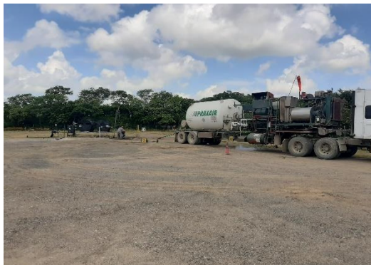
Registro Fotográfico No 3. Actividad operativa de inducción de N2 en el Pozo La Laja 11DEL.
