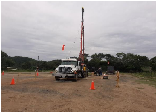
Registro Fotográfico No 7. Actividad operativa con unidad de suabeo, para calibración de pozo e inducción mecánica y recuperación de fluido de trabajo en pozo Laja 11DEL
