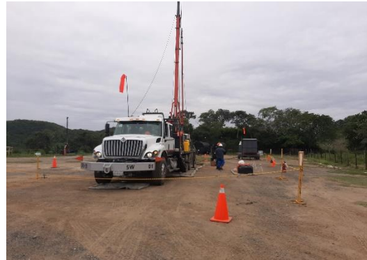
Registro Fotográfico No 7. Actividad operativa con unidad de suabeo, para calibración de pozo e inducción mecánica y recuperación de fluido de trabajo en pozo Laja 11DEL
