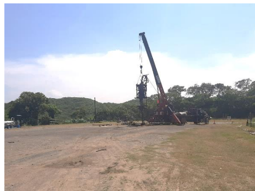
Registro Fotográfico No 2. Actividad operativa con Unidad de tubería Flexible para recuperación de sarta de velocidad en el Pozo La Laja 11DEL.
