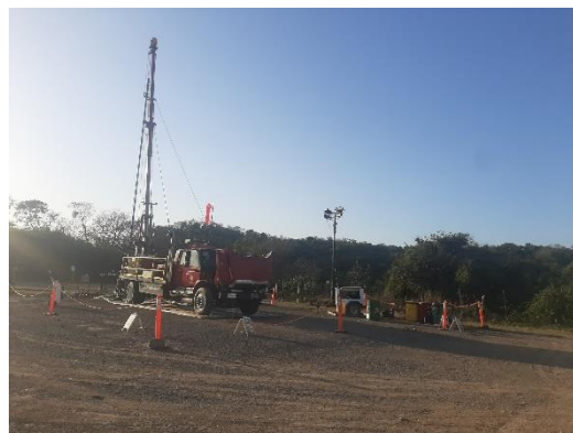
Registro Fotográfico No 18. Actividad de suabeo, mediante calibración de pozo e inducción mecánica y recuperación de fluido de trabajo en pozo Laja 11DEL.
