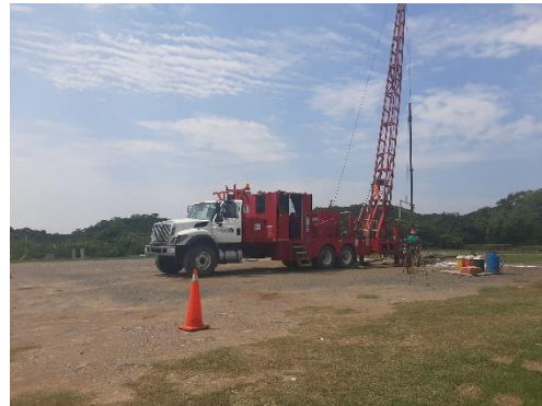
Registro Fotográfico No 6. Actividad operativa con unidad de suabeo para calibración de pozo con cortador de parafina en pozo Laja 11DEL.
