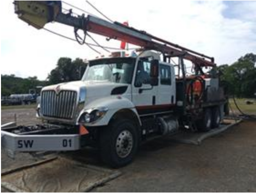
Registro Fotográfico No 10. Actividad operativa de inducción mecánica con unidad de suabeo en pozo Laja 11DEL .
