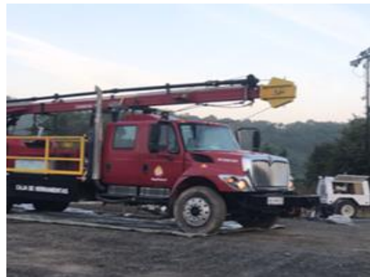
Registro Fotográfico No 16. Actividad de calibración de pozo e inducción mecánica y recuperación de fluido de trabajo en pozo Laja 11DEL.
