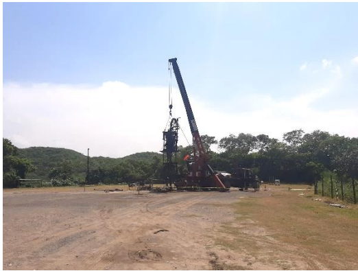
Registro Fotográfico No 2. Actividad operativa con Unidad de tubería Flexible para recuperación de sarta de velocidad en el Pozo La Laja 11DEL.
