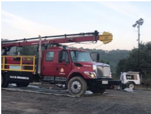
Registro Fotográfico No 15. Instalación de unidad de swab, para realizar actividad de calibración de equipo de control de presión y viajes de inducción mecánica, en pozo La Laja 11DEL.
