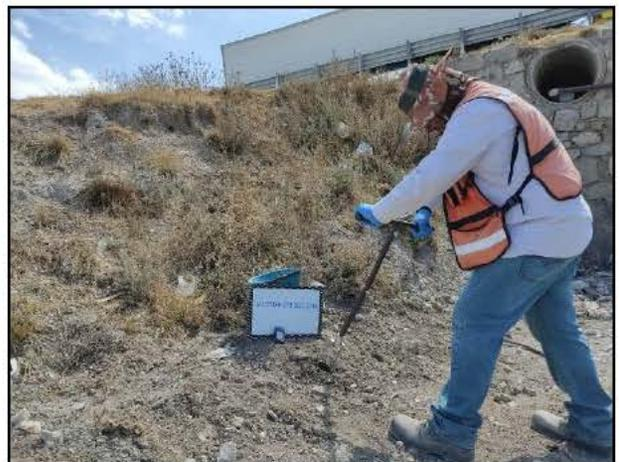
6. Toma de muestra en la pared de la Zona de Excavación.
