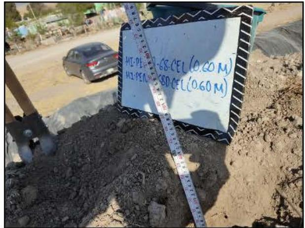
10. Se realizó la medición de las profundidades en los puntos de muestreo con apoyo de una cinta métrica.
