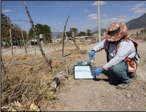
7. Se realizó la toma de muestras superficiales en la periferia de la Zona de Excavación con apoyo del cucharón de acero inoxidable.
