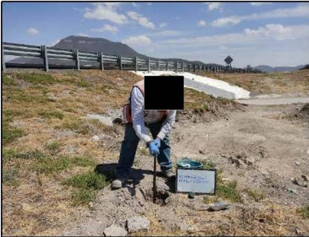
9. Con apoyo de Hand Auger se tomaron muestras a diferentes profundidades. Toma de muestra en la periferia de la Zona de Excavación.
