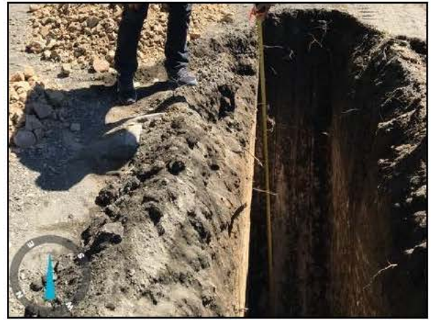
09. En el sitio en estudio se encontró Infiltración Alta y textura arcillosa.
