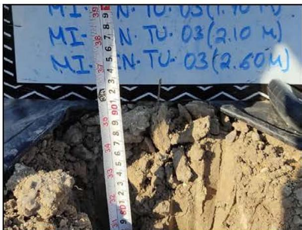
05. Las profundidades de los puntos de muestreo fueron verificadas con apoyo de flexómetro.
