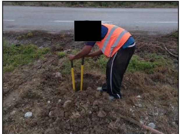
05. Se realizaron sondeos manuales en el área afectada a fin de determinar la pluma del contaminante.
