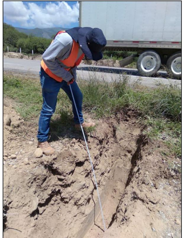
09. Con apoyo de flexómetro se corroboró la infiltración del hidrocarburo en el sitio afectado.
