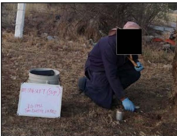
11 - Se recogió una muestra testigo fuera del área afectada y con apoyo de un Cucharón de acero inoxidable.
