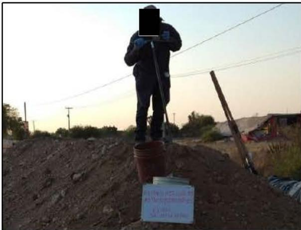
09 - Con apoyo de un Hand auger se tomaron muestras en la Celda Provisional.
