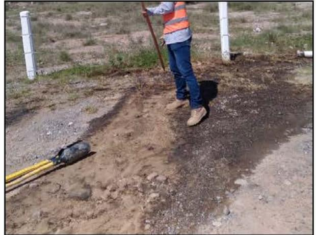
02 - Afectación evidente en el suelo natural del sitio, a partir del derrame de Turbosina.
