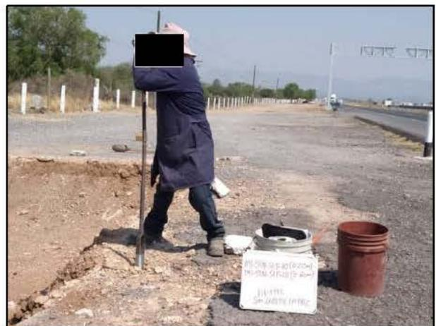
06 - Con apoyo de un Hand auger de acero inoxidable se tomaron muestras en las periferias de la Zona de Excavación A.
