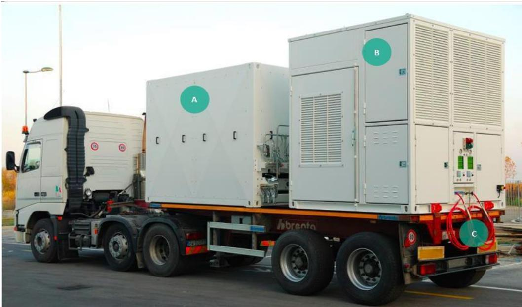
**A.** Tanque de almacenamiento de GNV.      **B.** Equipo de compresión de GNV.      **C.** Mangueras de descarga de GNV.
