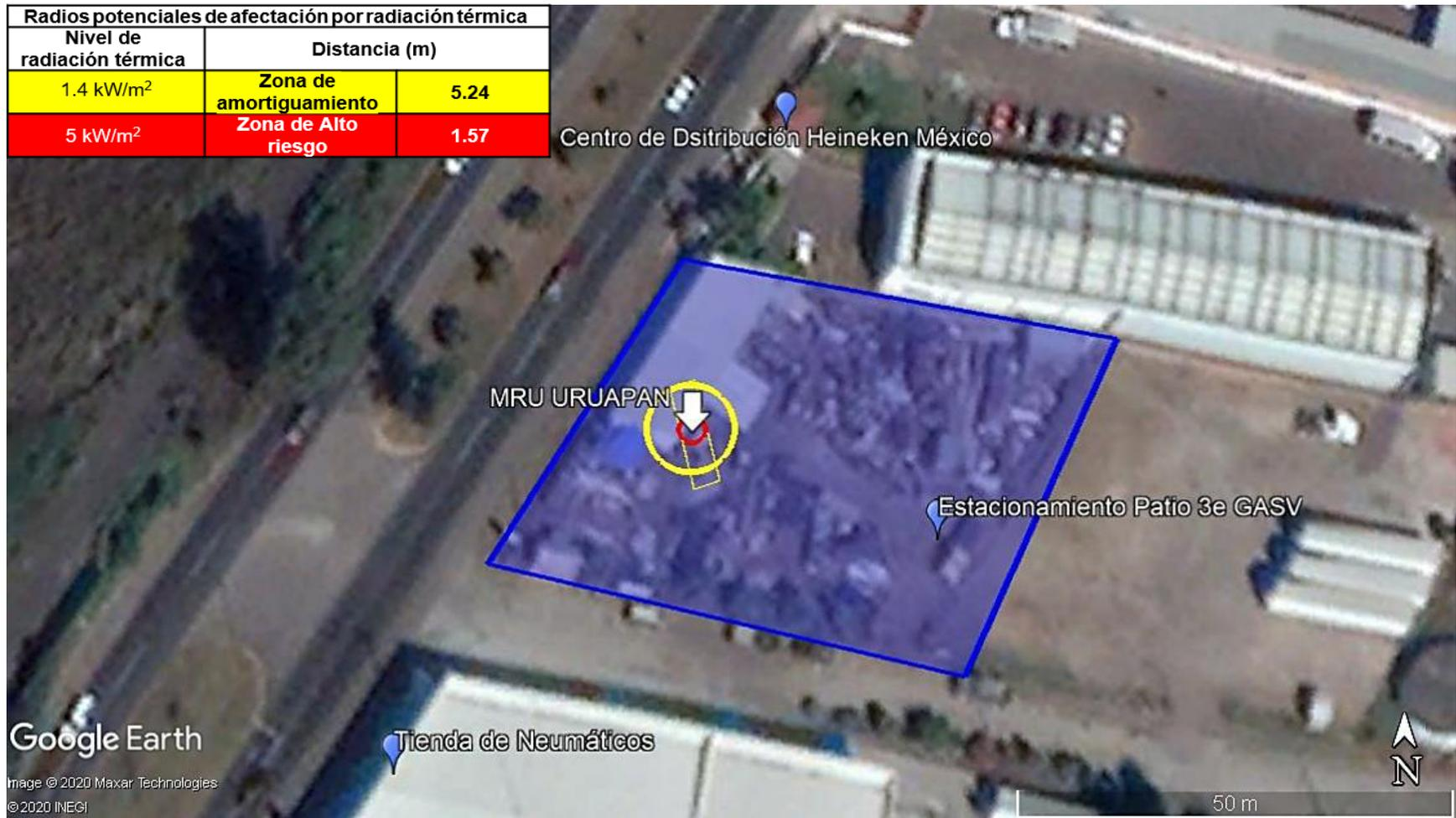
**Figura 33. Radios de Afectación por Radiación Térmica para el Escenario 2. Incendio por fuga en tubería de entrada al compresor, no mayor a 1 kg. Más probable, menos catastrófico.**
