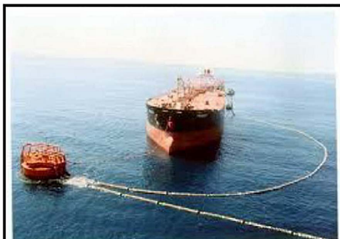
Figura .4.- Buque tanque en amarre y descargando en monoboya.
