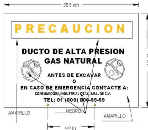
Figura II.56. Diagrama de señalización tipo
