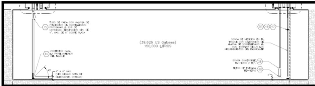
Figura 5. Tanques subterráneos de doble pared de acero al carbón y revestidos con fibra de vidrio.
