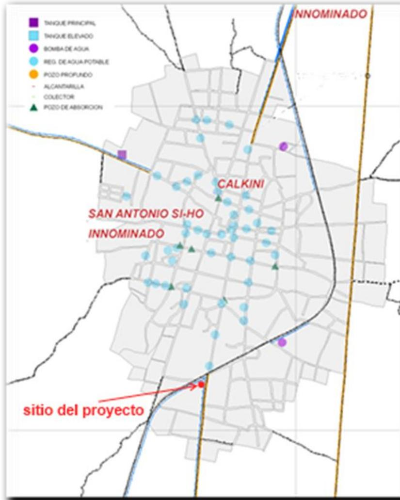
**Ilustración 75. Sistema de distribución de agua potable para la ciudad de Calkiní.**
