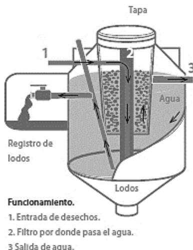
Determine la posición de la válvula y cave un espacio donde se instalará el Registro de Lodos. La distancia entre el Biodigestor y el Registro debe ser menos a 2 m, la pendiente de la tubería será del 2%.
