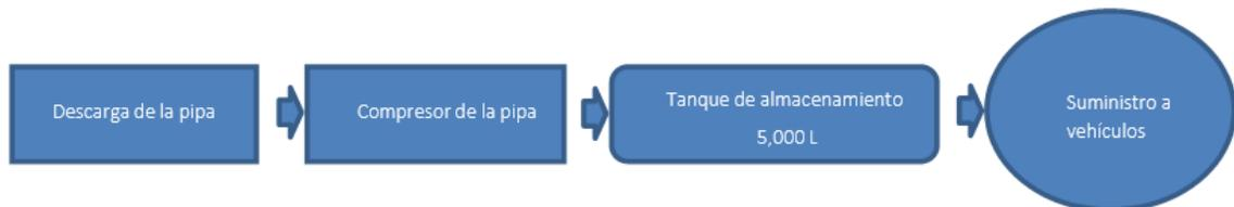
*Figura 5. Diagrama de flujo de la estación de carburación del Proyecto*
