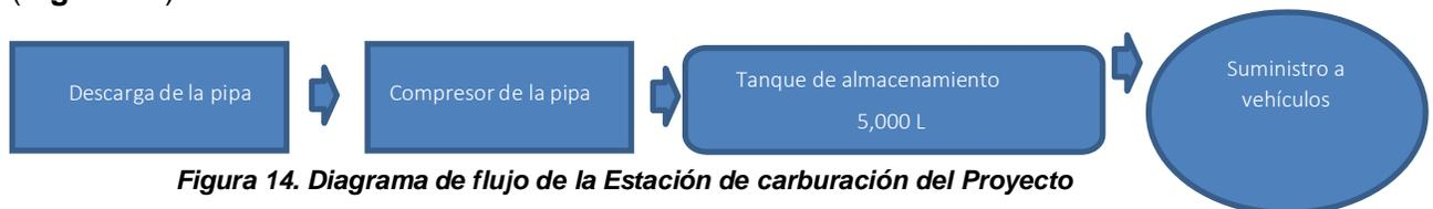
Figura 14. Diagrama de flujo de la Estación de carburación del Proyecto
