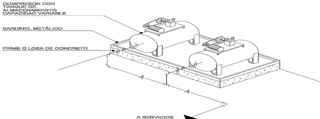
**IMAGEN 9. ISÓMETRICO COMPRESOR AIRE**
