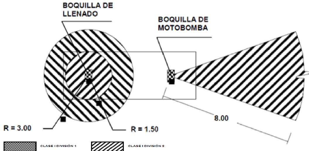
**IMAGEN 4 CLASIFICACIÓN DE ÁREA PELIGROSA TANQUE DE ALMACENAMIENTO**
