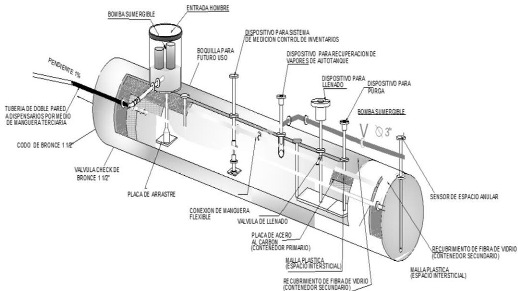
**IMAGEN 5. ISOMÉTRICO TANQUE DE ALMACENAMIENTO DOBLE PARED**
