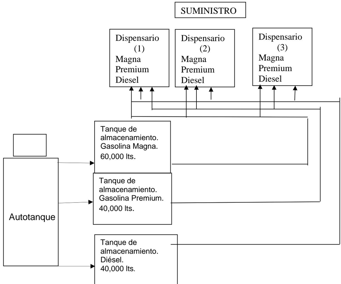
Los combustibles se transportaran en autotanques autorizados por PEMEX, para ser descargados en los tanques de almacenamiento de la Estación de Servicio, por personal autorizado y debidamente capacitado; posteriormente serán suministrados directamente en los tanques de los vehículos automotores.
