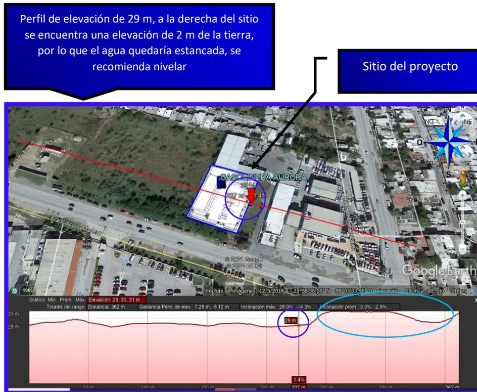
*Ilustración 8. Perfil de elevación*
