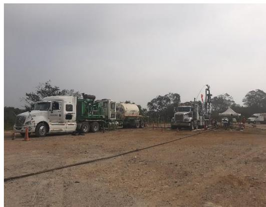
**Registro Fotográfico No 6.** Actividad con unidad de tubería flexible molino y motor de fondo, pesca de válvula de pie y lavado e inducción de pozo con nitrógeno (N<sub>2</sub>) en pozo La Laja 11DEL.
