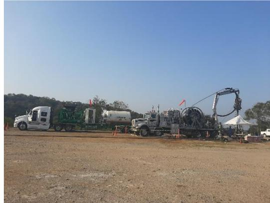
**Registro Fotográfico No 14.** Instalación de unidad de tubería de flexible y equipo de apoyo en el arme UAP, N2, para la realización de la colgada de sarta de velocidad en el pozo La Laja 11DEL.
