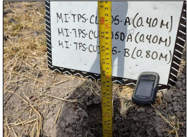
10. Con apoyo de flexómetro se realizó la medición de las profundidades en los puntos de muestreo. La ubicación de los puntos de muestreo se determinó con apoyo de GPS.
