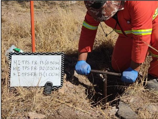
07. Se realizó la toma de muestras a diferentes profundidades en las periferias de la Fosa de Excavación.
