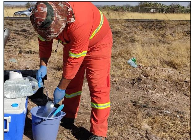
10. Entre cada toma de muestras se realizó el lavado del equipo utilizado con jabón libre de fosfatos y agua destilada.
