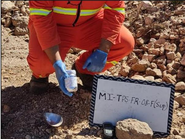
03. Los puntos de muestreo fueron identificados de acuerdo con el plan de muestreo. La ubicación de dichos puntos se determinó con apoyo de GPS.
