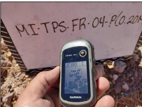
17. Los puntos de muestreo fueron identificados en una pizarra y de acuerdo con el plan de muestreo. Las coordenadas de los puntos de muestreo fueron tomadas con apoyo de un GPS.
