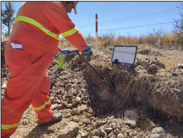
05. Con apoyo de Hand Auger de acero inoxidable se realizó la toma de muestras en la pared de la Fosa de Excavación.
