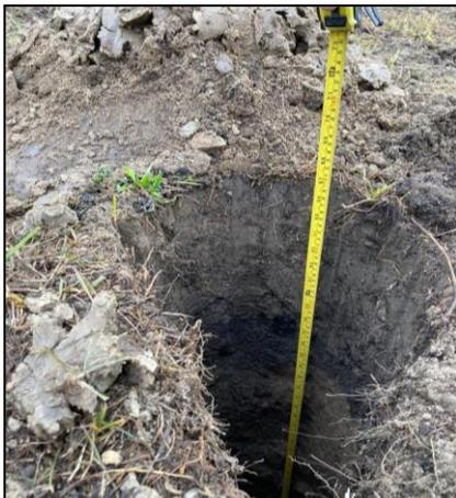
5. Las mediciones se tomaron con un flexómetro, además, se observa un tipo de suelo limoso.
