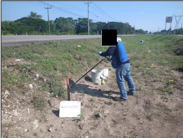
7. Se realizó la toma de muestras a diferentes profundidades en las paredes de la Fosa de Excavación.
