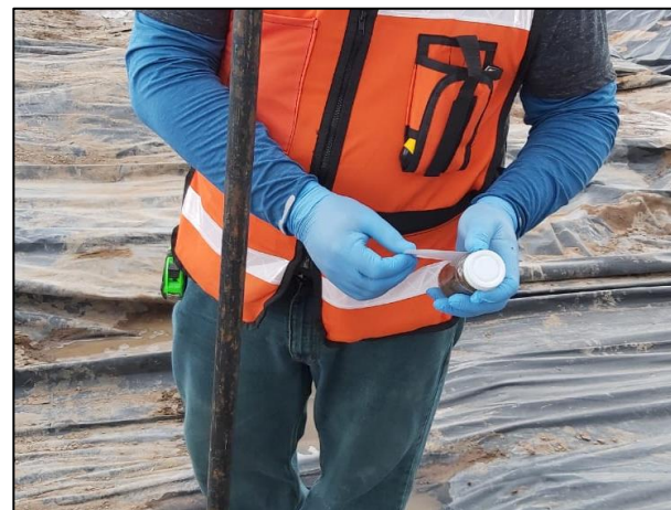
6. Una vez depositada la muestra en frascos de vidrio, se procedió al respectivo etiquetado y sellado de ésta.
