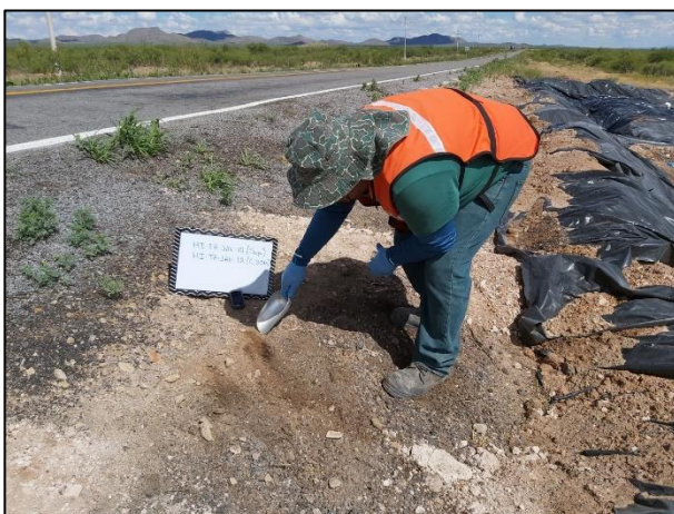
12. Con apoyo del cucharón de acero inoxidable se realizó la toma de muestras superficiales.
