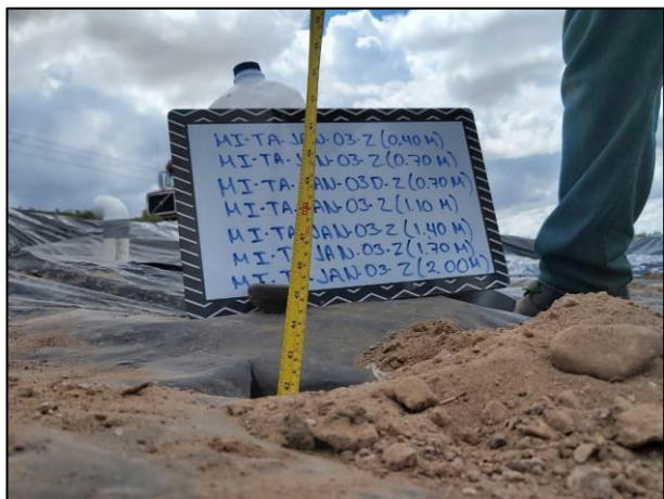
7. Las profundidades de los puntos de muestreo fueron verificados con apoyo de un flexómetro.
