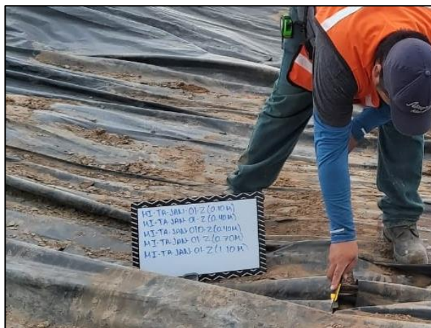
4. Se realizó incisiones sobre la película de polietileno de alta densidad, con la finalidad de tomar las muestras en los puntos de muestreo.
