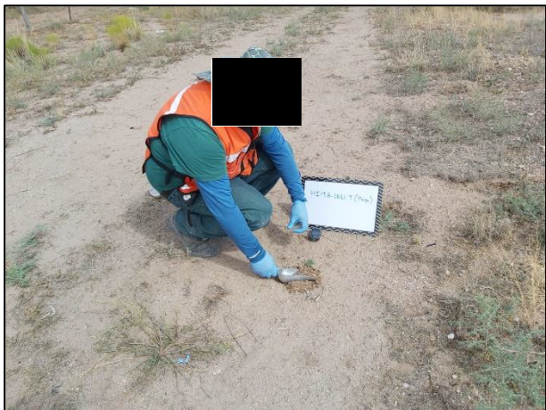
13. Toma de muestra testigo fuera del área afectada.
