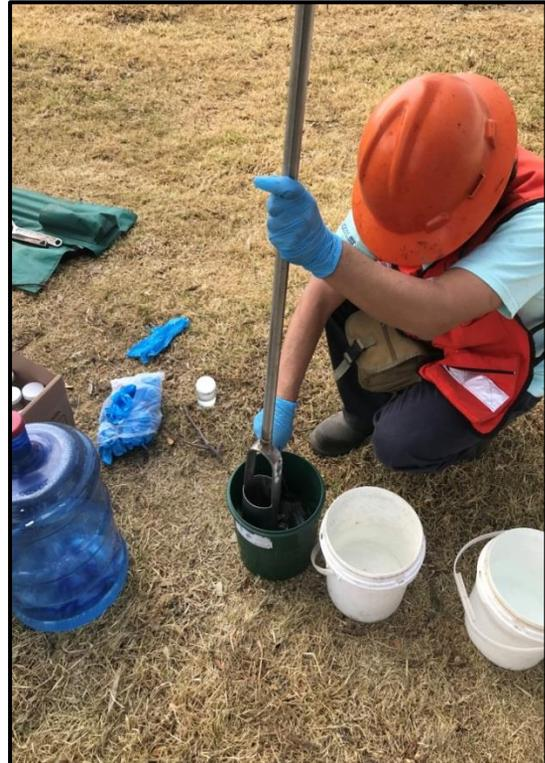
LAVADO DE LA HERRAMIENTA UTILIZADA PARA LA TOMA DE MUESTRAS DE SUELO.
