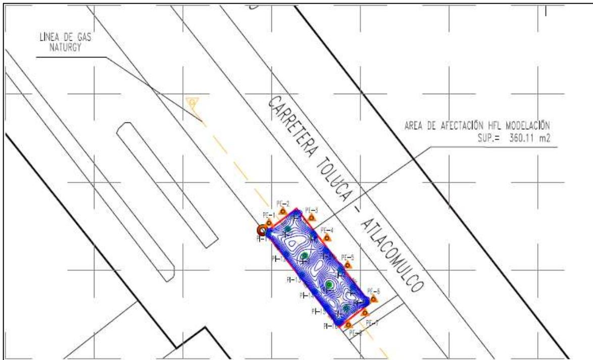
**Figura 12.** Simulación de la pluma contaminante de Hidrocarburos Fracción Ligera a 0.20 m
