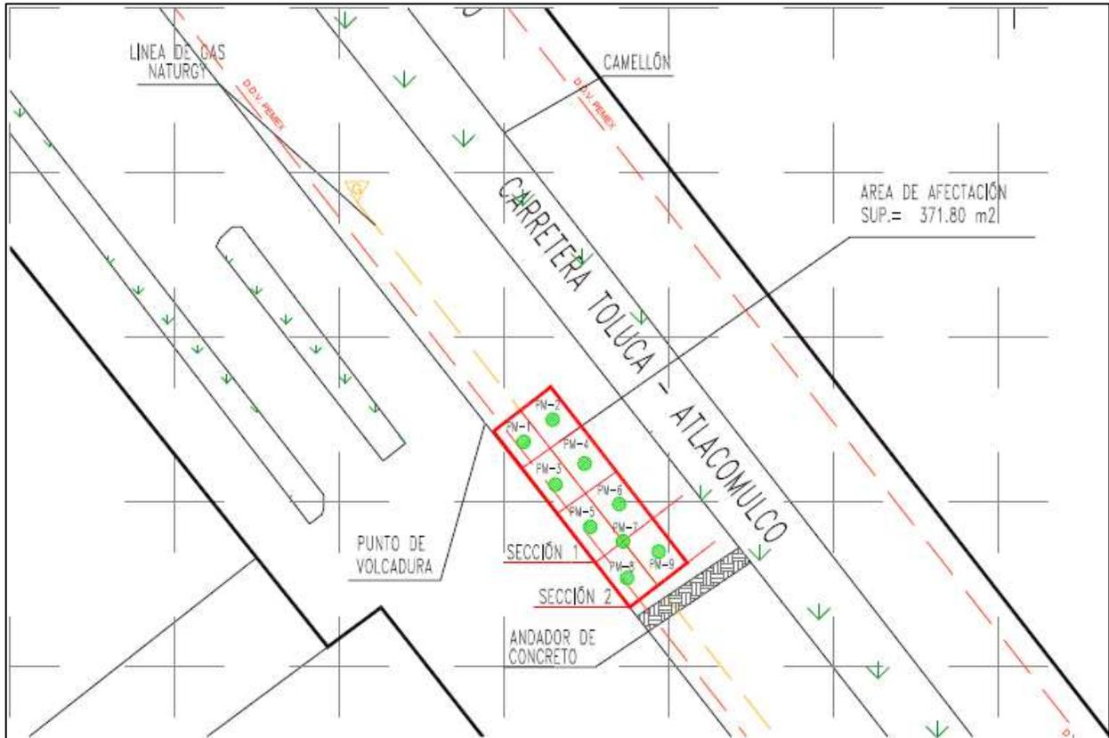
**Figura 1.** Esquema para ubicación de los Puntos de Muestreo dentro del área afectada por derrame de Gasolina
