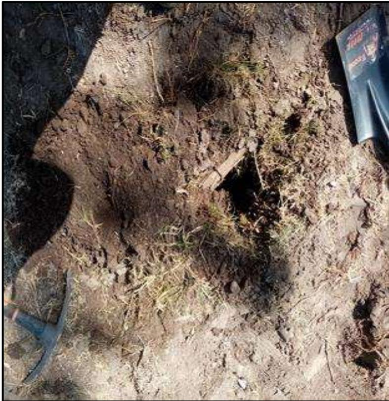
**Figura 17.** Suelo contaminado con HFL hasta 0.90 m. Sondeo inicial.
