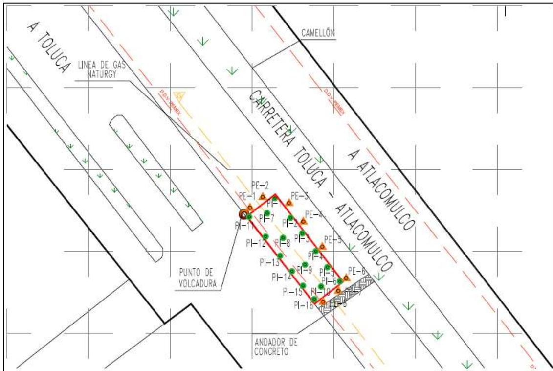
**Figura 5.** Ubicación de los puntos de muestreo en el área afectada por el derrame de Gasolina
