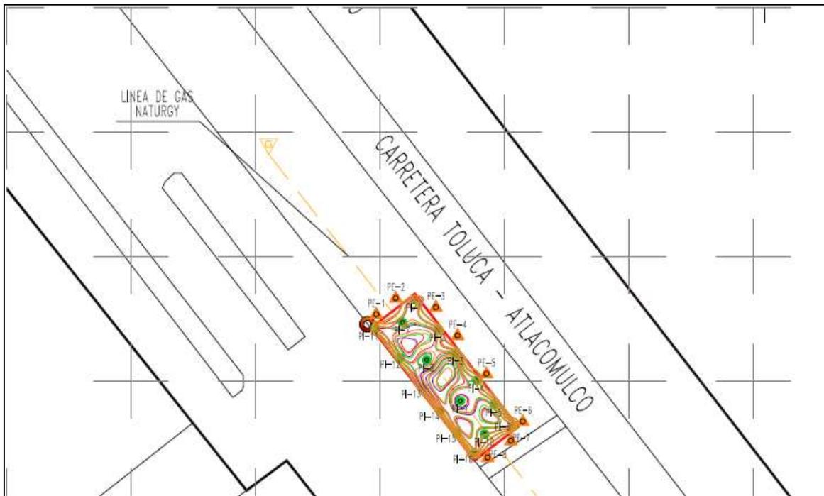
**Figura 13.** Simulación de la pluma contaminante de BTEX a 0.20 m
