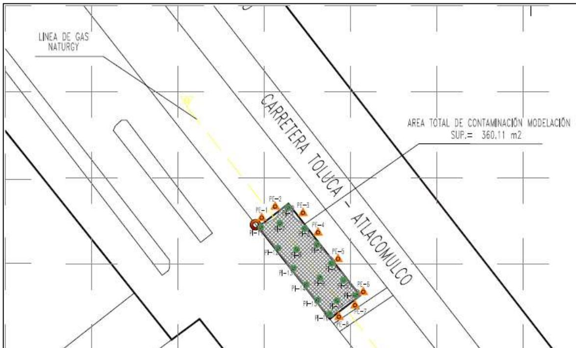
**Figura 14.** Integración de las Plumas Contaminantes determinadas por el modelo de simulación para Hidrocarburos Fracción Ligera, Benceno, Tolueno, Etilbenceno y Xileno.
