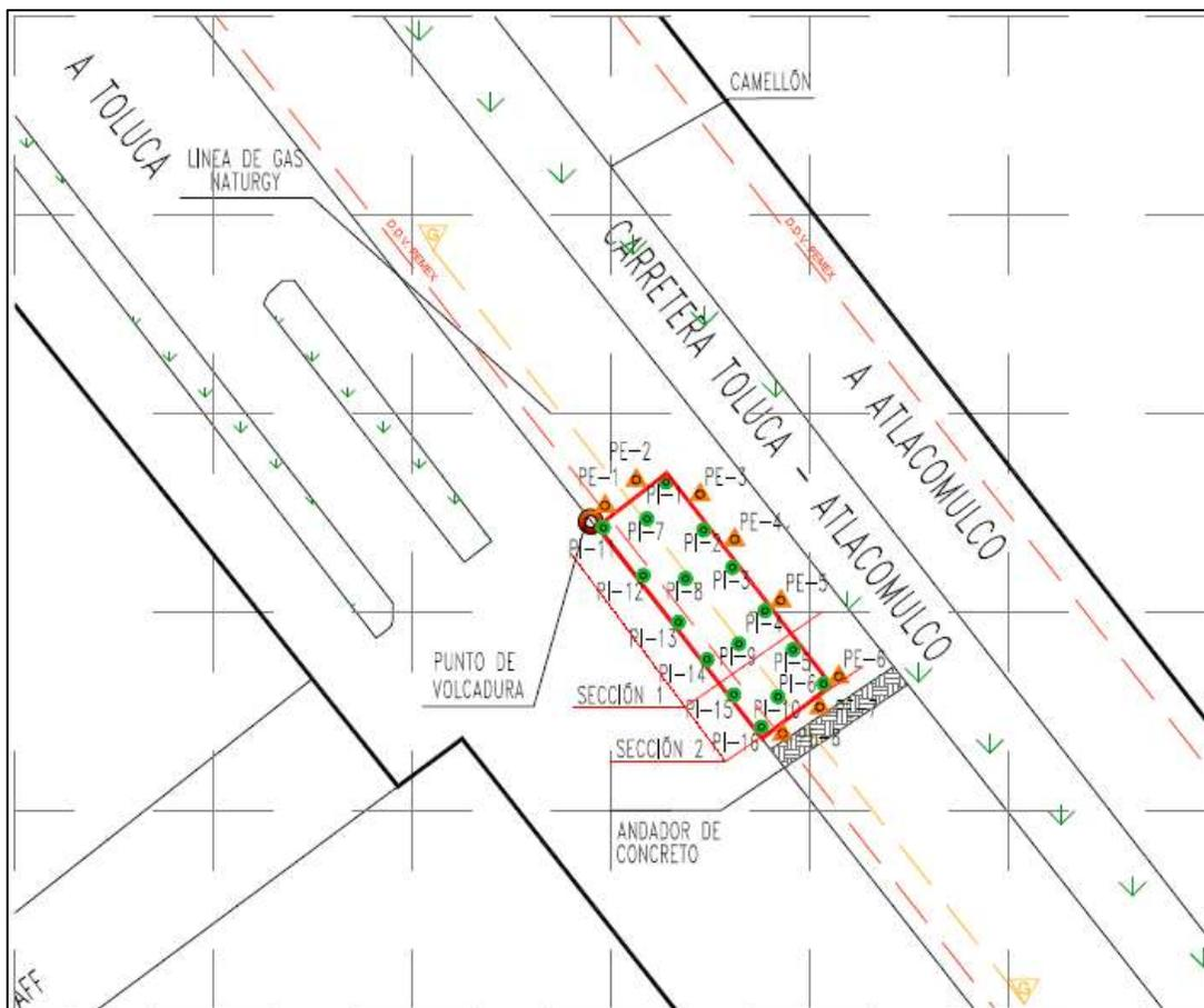
**Figura 11.** Seccionamiento del área afectada para el cálculo del volumen.
