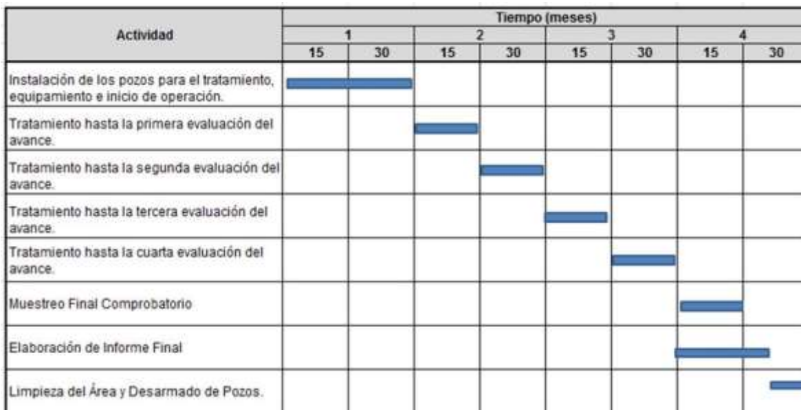
Figura 21. Cronograma para realización del Tratamiento de "Bioventeo Aerobio en el Sitio Contaminado"
