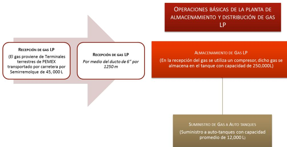
Figura 31. Operaciones Básicas de la Planta de Almacenamiento y Distribución de Gas LP.
