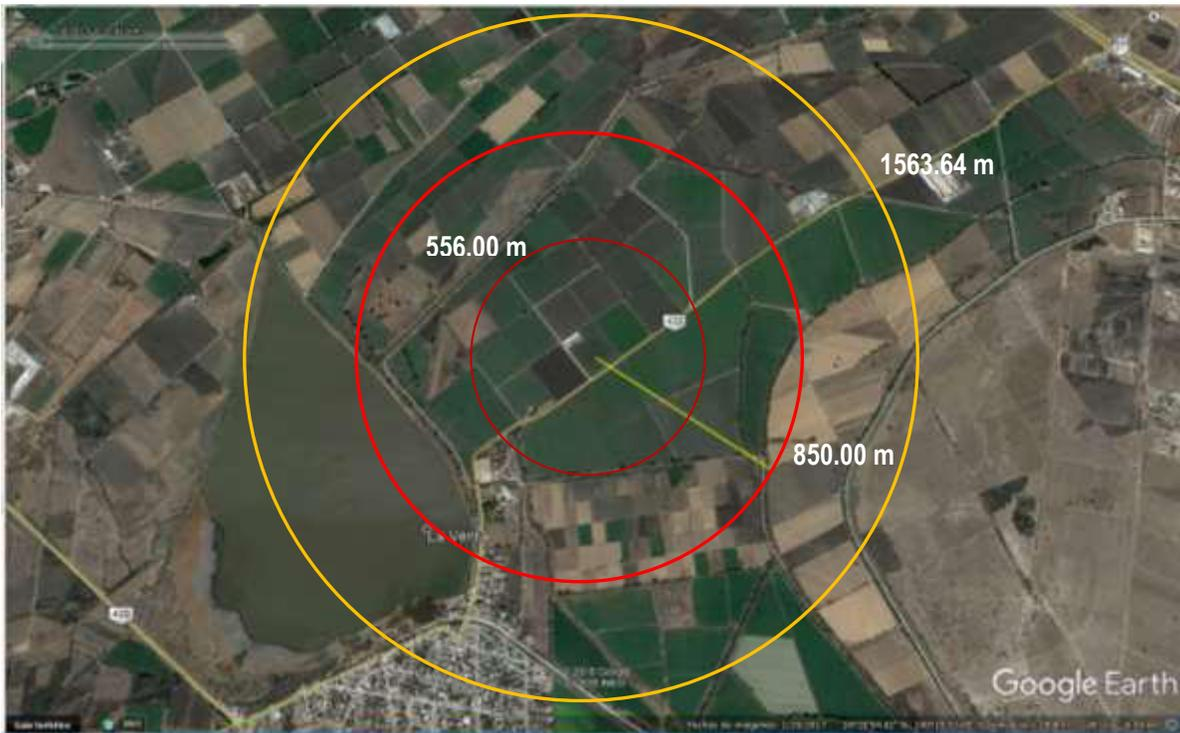
También se llevó a cabo la simulación de un siniestro en el tanque de almacenamiento de mayor capacidad (250,000 litros) bajo la ocurrencia de una BLEVE cuando el tanque se encuentra lleno al 85% de su capacidad. El gas involucrado en este evento tiene una masa de 123,250 kg.
