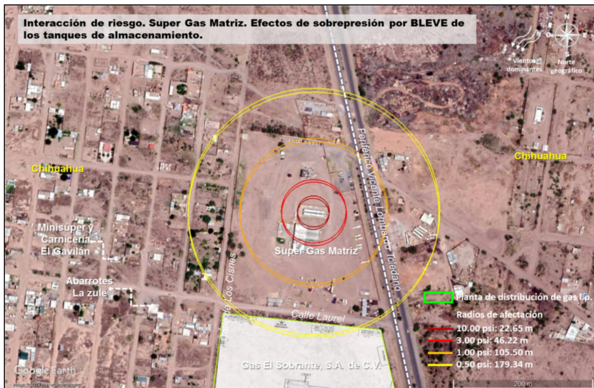
Figura II.3.13. Radios de afectación por sobrepresión de la BLEVE del tanque de la Estación.
