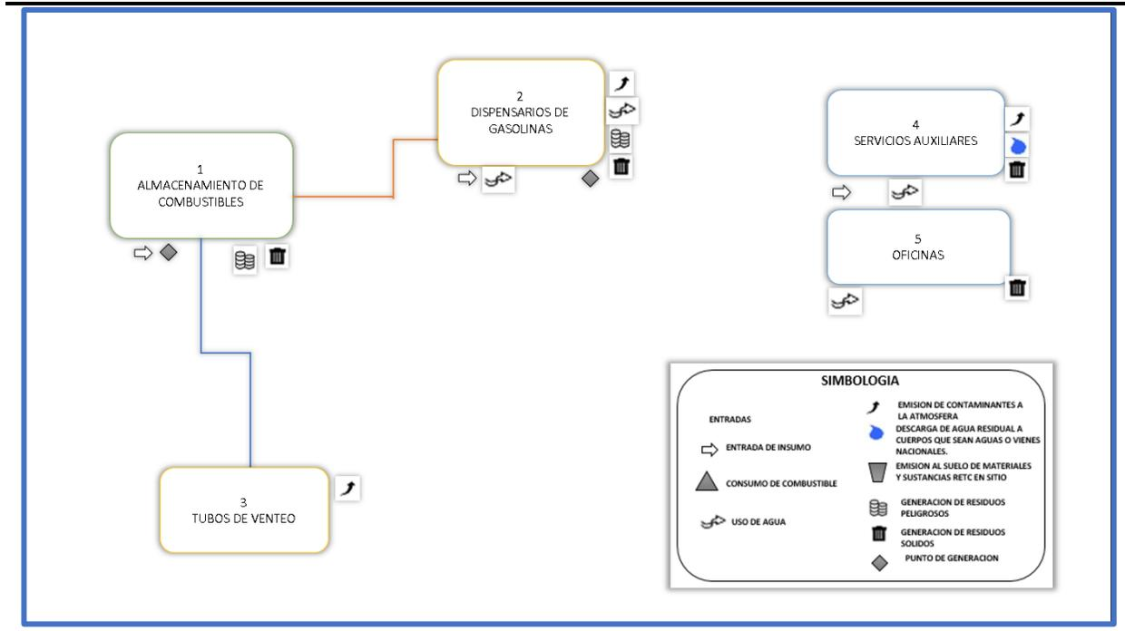
Figura 8. Diagrama de funcionamiento general de la Estación de Servicio.
