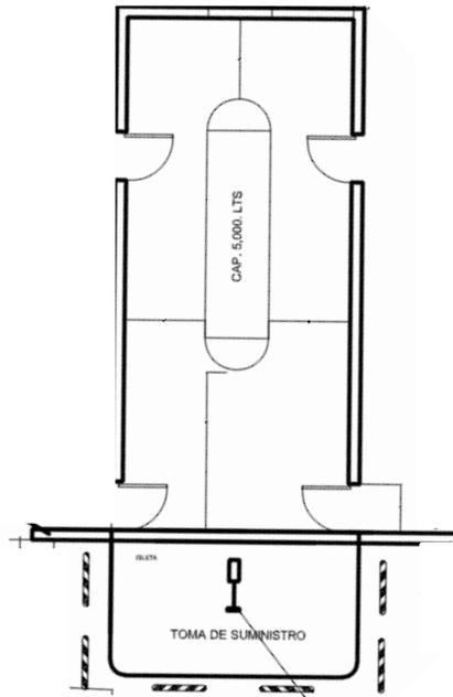
El recipiente se instala sobre bases de sustentación metálicas, estas bases de sustentación permiten los movimientos de dilatación y contracción del recipiente. Todas las salidas de líquido y vapor cuentan con válvulas de exceso de flujo vigentes, está conectado a la línea general de tierra.
