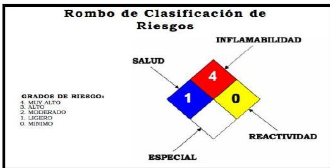
Ilustración 23. Rombo de seguridad para Gas L.P.
