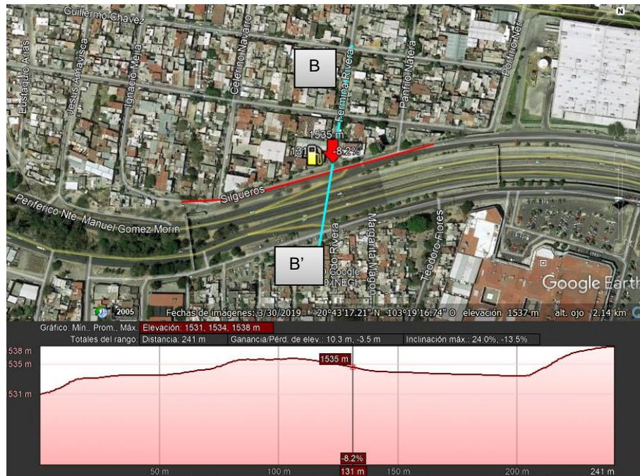
Imagen 34. Perfil de elevación del predio en estudio, la ruta está trazado con orientación transversal (B-B').
