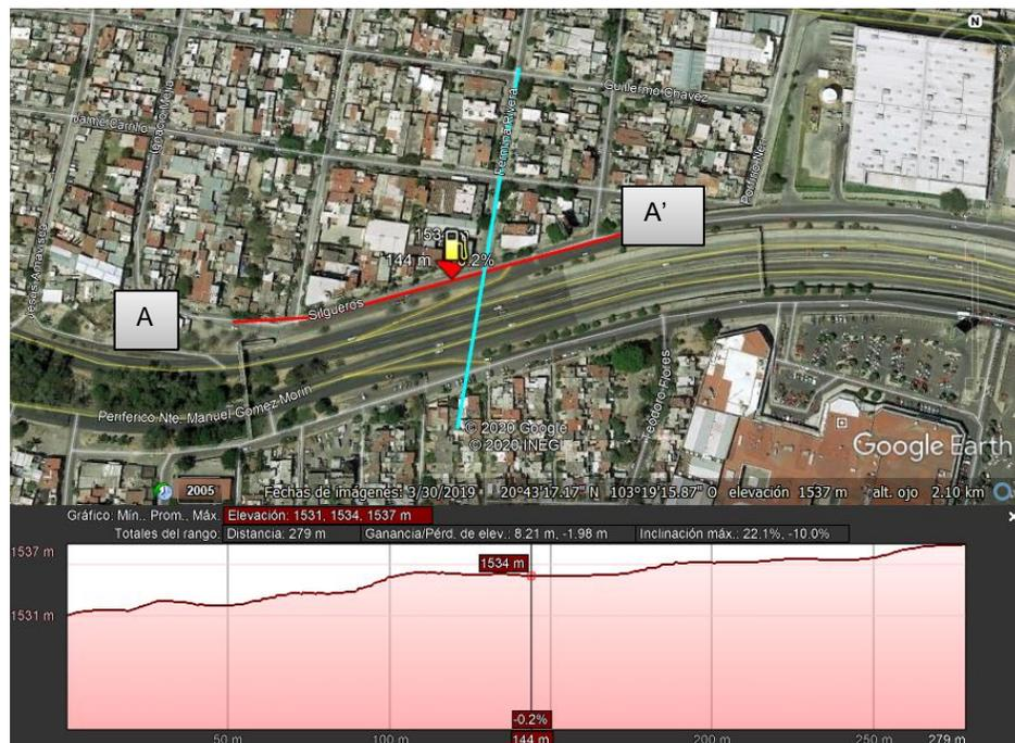
**Imagen 33.** Perfil de elevación del predio en estudio, la ruta está trazado con orientación longitudinal (A-A').
